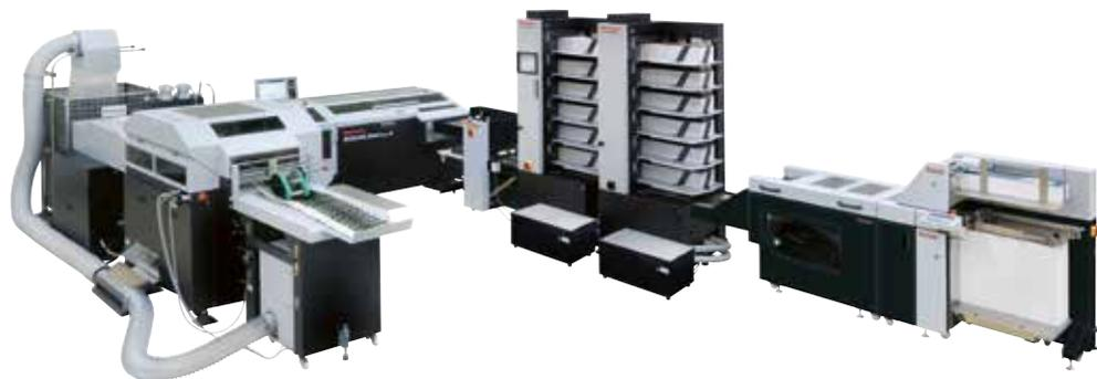
neuen Modells liegt in der Steuerung der Luft in den Stationen. Individuelle und optimierte Luftzufuhr aus zwei Lüftern separat für jede Station und zuverlässige Saugtrommelanleger sorgen für einen sicheren Papiereinzug. Überlappung, Geschwindigkeit, Saug- und Blasluft sind individuell einstellbar und ermöglichen so die Verarbeitung auch kritischer Papiere und Formate. Im Zusammentragmodus kann der VAC-L600H bis zu 9.900 Sätze pro Stunde verarbeiten. In
